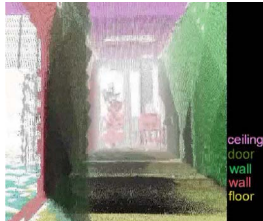
Visualisierung eines Punktemodells eines Büroflurs (AVZ-Gebäude, 5. Etage) mit Interpretationen von Gebäudeflächen und Objekten
