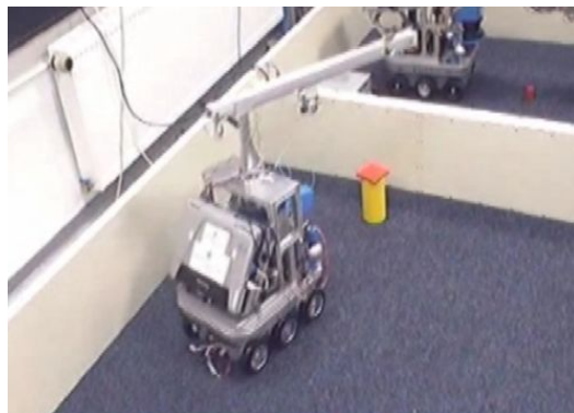
Ein Roboter vom Typ KURT3D mit Greifmechanismus (Kran-Arm) nähert sich einem potenziell anhebbaren Objekt. Der Roboter registriert die Affordanz „greifbar“ unabhängig von einer Objektklassifizierung und kann ein entsprechendes behavior anstoßen.
