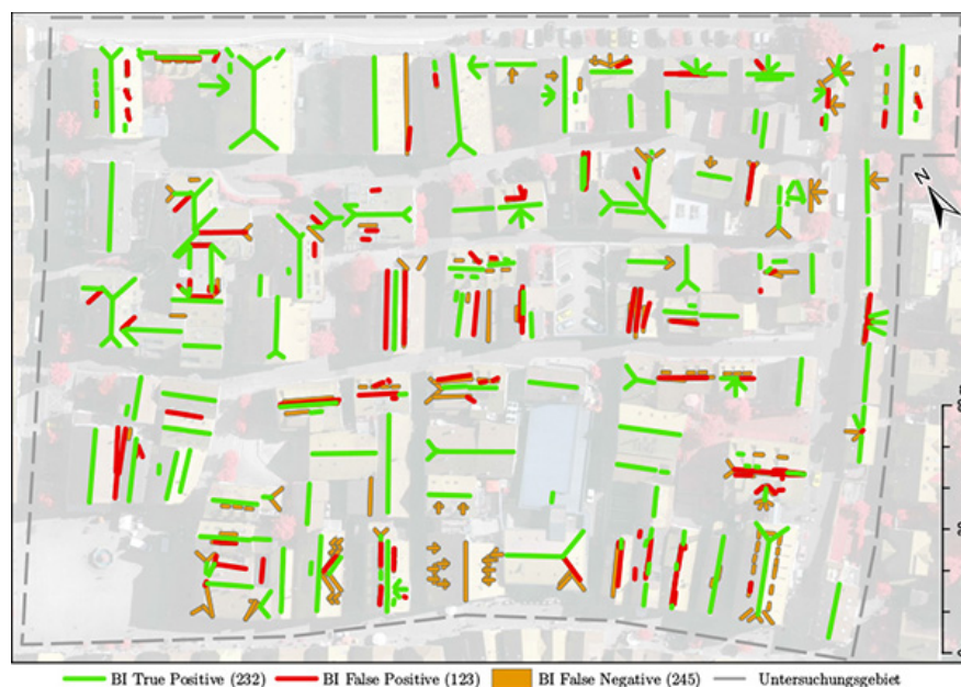
Abbildung 5.7: Schnittkantenbestimmung mit boolescher Schnittmenge (0,5 m Puffer).
