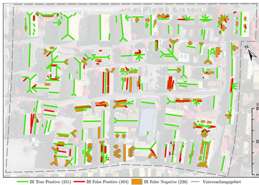
Abbildung 5.6: Schnittkantenbestimmung mit boolescher Schnittmenge (1 m Puffer).
