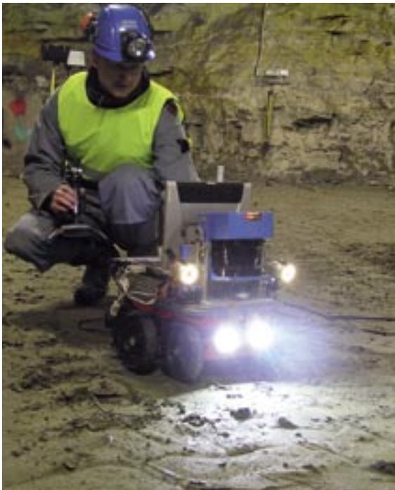
KURT-3D bei einem Kartierungs-Experiment in der Kvarntorp Mine bei Örebro, Schweden.
